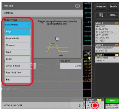
要进行总线触发，必须首先将总线添加到波形视图中。见 [Add a math, reference, or bus waveform](#)
