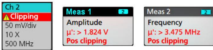
要关闭限幅消息，请更改垂直刻度以显示整个波形，将探头端部与过高电压源断开，并确认您正使用合适的探头探测合适的信号。
