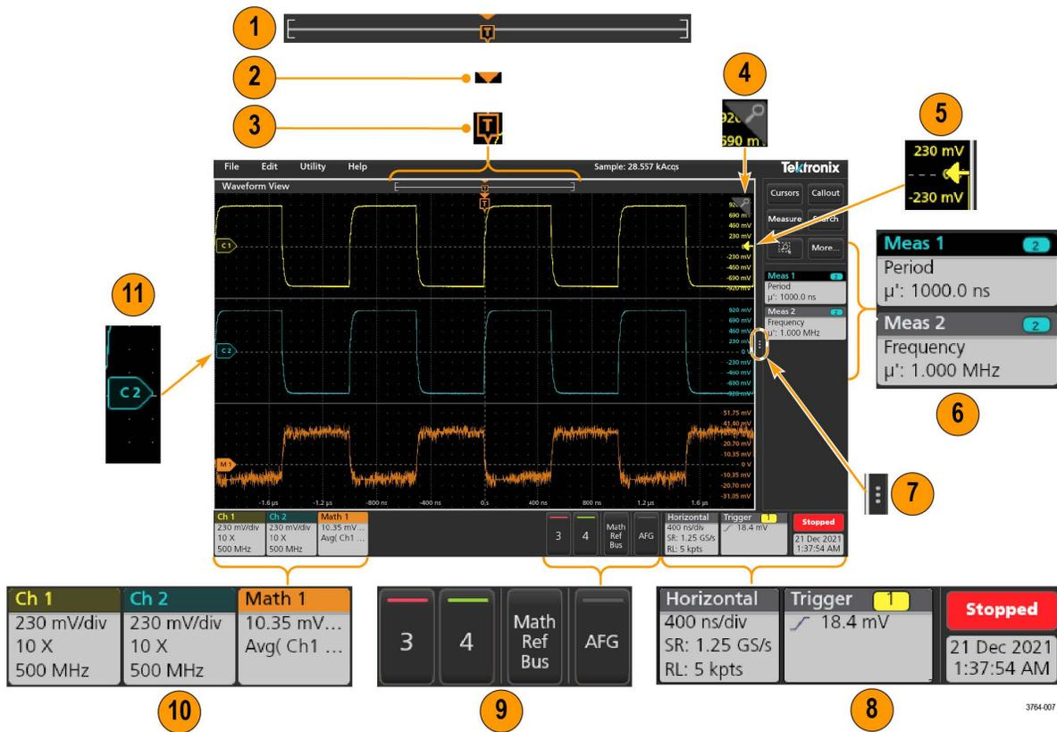
1. “波形记录视图”为图形化高级视图，包括整个波形记录长度、屏幕上的记录数量（以括号显示）、包括触发事件在内的主要时间事件位置以及当前波形光标位置。
