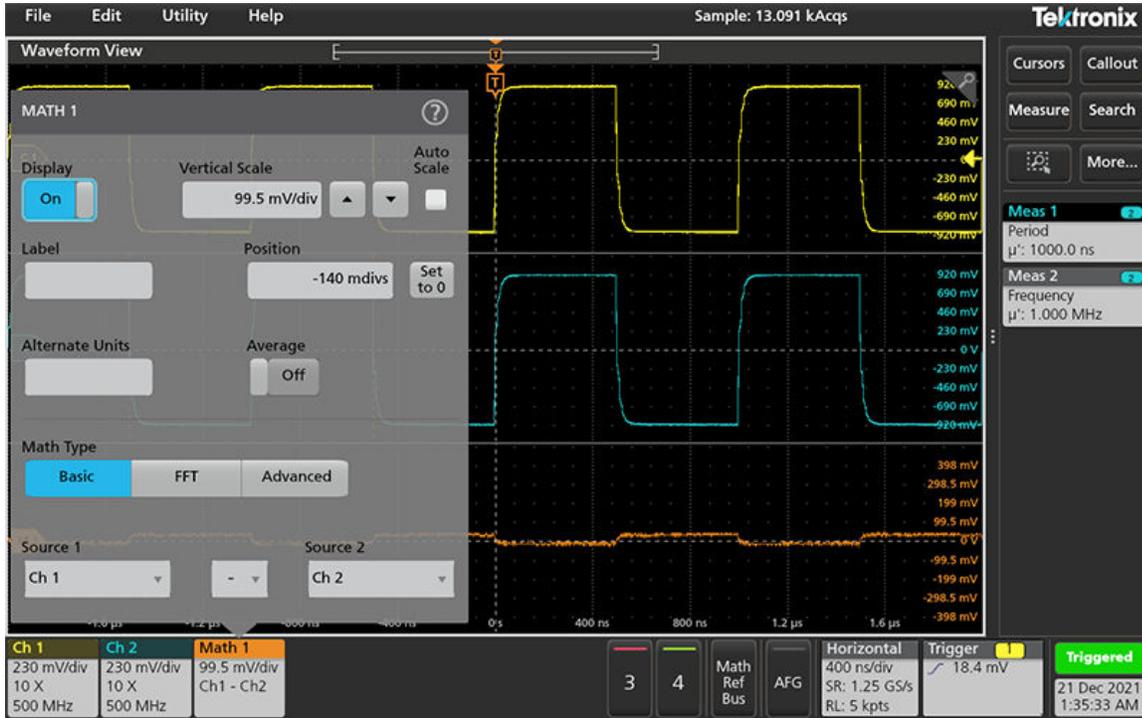
3. 使用配置菜单优化波形参数。所显示的字段将取决于菜单中的波形和选项。选项更改将立即生效。本例说明如何添加数学波形、使用数学 **Source（源）** 字段将通道 1 和通道 2 选择为波形源并将数学类型设置为 **Basic（基本）** 数学运算，以及从通道 1 中减去通道 2。
