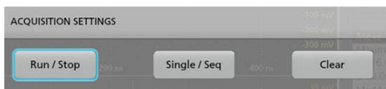
3. 要停止采集，请再次点击**运行/停止**，或按 **运行/停止**按钮。点击“设置”栏上的**正在运行**按钮以停止采集。
