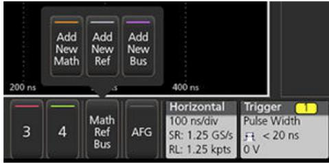
2. 仪器会将波形添加到 Waveform View（波形视图）中，将 Waveform（波形）标记添加到 Settings（设置）栏中，并打开配置菜单。本示例说明如何添加数学波形。
