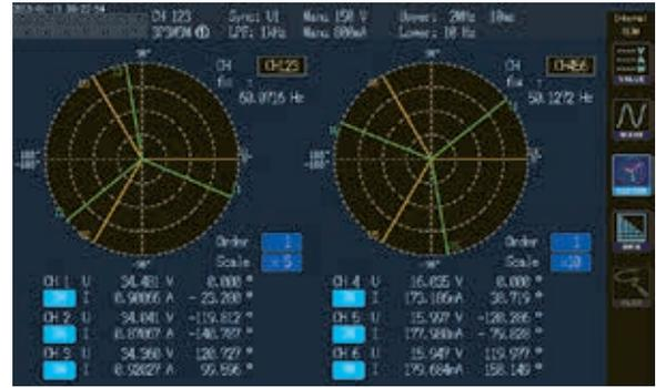
功率基本精度 $\pm 0.05\%$  ( $\pm 0.02\%$  rdg,  $\pm 0.03\%$  f.s. 主机精度)
