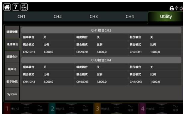
通道耦合简化了双通道的操作。两个通道都可以用一个参数来控制相位，幅度或频率，使得创建偏差或比例信号变得简单。
