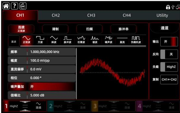
打开噪声叠加功能，可以调节信号输出的信噪比。在通信行业研发测试系统中可以模拟不同信噪比条件下的工作性能，从而模拟真实的工作状态。
