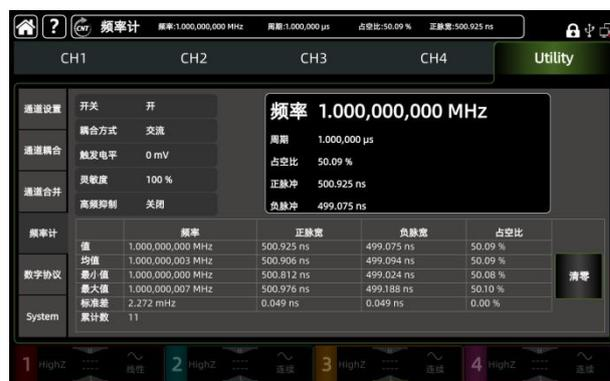
高精度硬件频率计，可测 100mHz ~ 800MHz 的频率范围。
