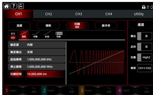
支持“线性”，“对数”，“步进”和“列表”四种扫频方式，“内部”，“外部”和“手动”三种触发源。
