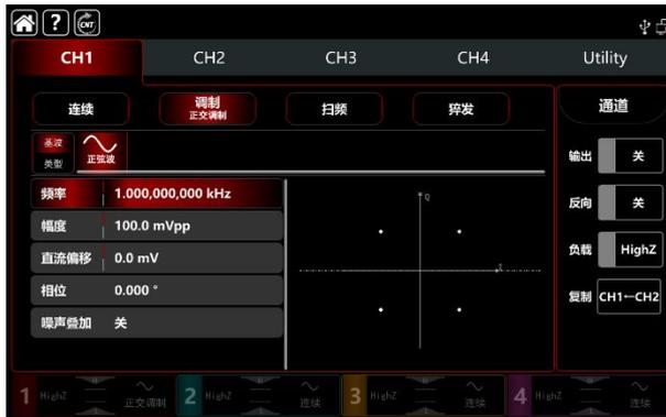
触摸频率数字，弹出虚拟键盘，使用虚拟键盘输入 2kHz。
