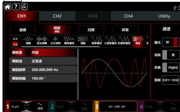
触摸调制相偏数字，弹出虚拟键盘，使用虚拟键盘输入 200°。
