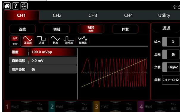
触摸幅度数字，弹出虚拟键盘，使用虚拟键盘输入 1Vpp。
