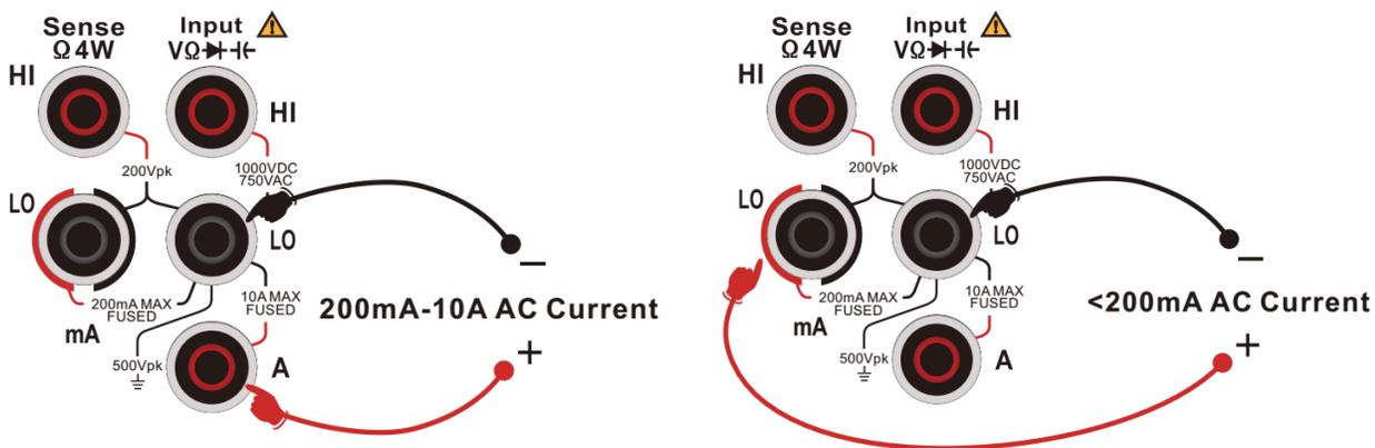
图 2 - 18交流电流测量连接示意图
