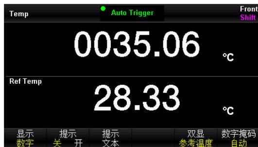
图 3 - 13 温度测量双显示界面 1
