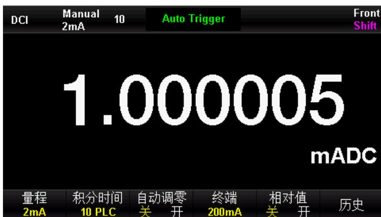
图 2 - 12 直流电流测量界面
