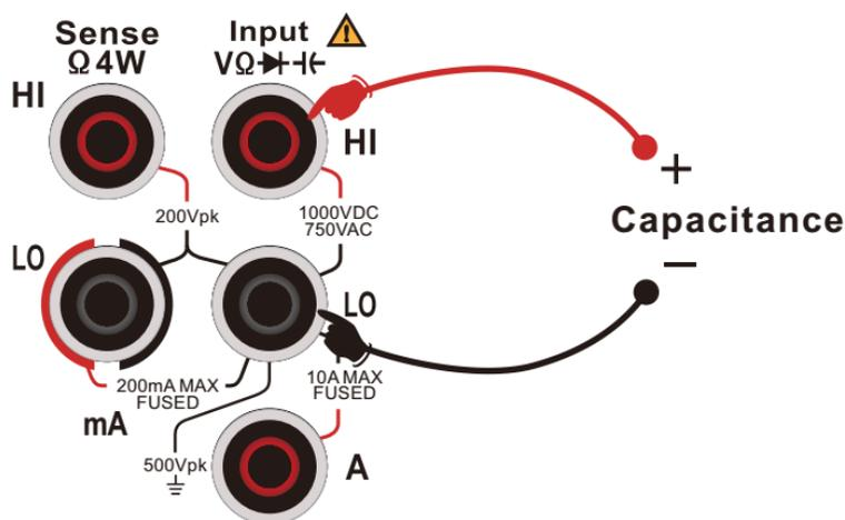
图 2 - 25电容测量连接示意图
