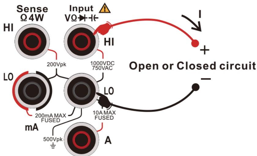
图 2 - 31 连通测量连接示意图
