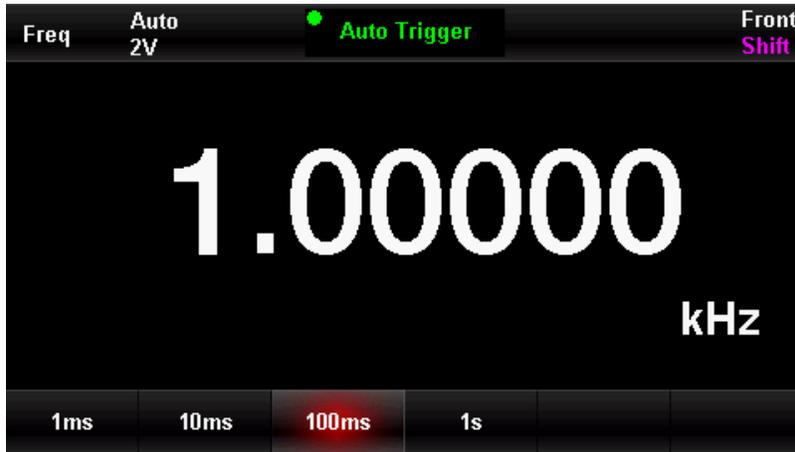
图 2-9 设置测量间隙时间
