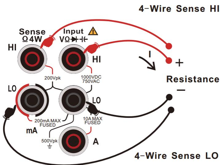
图 2 - 23四线电阻测量连接示意图
