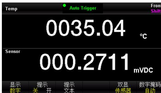
图 3 - 14 温度测量双显示界面 2
