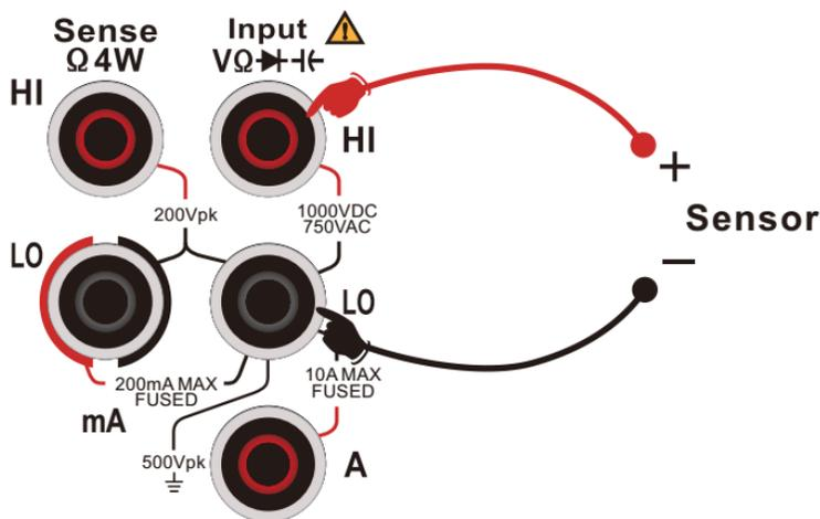
图 2 - 35 温度测量接线示意图
