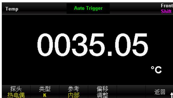
图 3 - 12 K型热电偶温度测量界面
